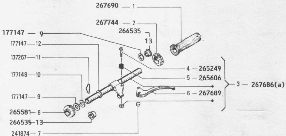
a) Con part./Avec pièces/With parts/Mit Teilen: 4-5-6.
