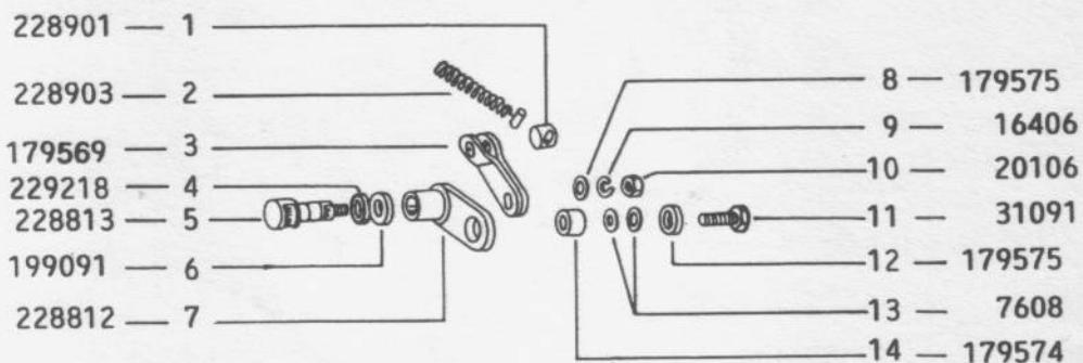
T.50 PEDALE-POMPA FRENO – PEDALE FREIN-POMPE FREIN – BRAKE PEDAL-BREAKER PUMP – BREMSPEDAL-HAUPTBREMSZYLLINDER
