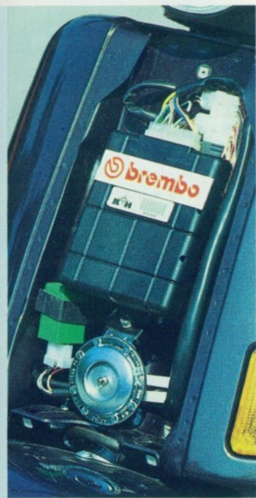
L'unità di controllo elettronico UCE, riceve le informazioni dal sensore applicato alla ruota anteriore e dalla pompa del freno a pedale per elaborare i dati di una frenata più sicura. È sistemata davanti al canotto di sterzo, protetto da un coperchio di plastica. Sotto c'è l'avvisatore acustico.
