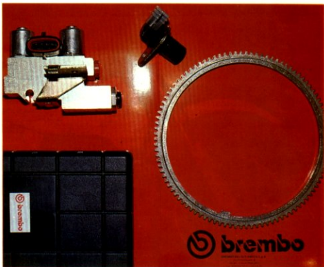
16) ABS Piaggio. Le componenti Brembo e, a sinistra, lo schema dell'Abs per la Cosa.
